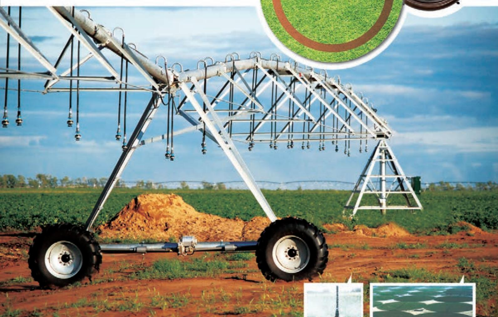
**中心支轴式喷灌机**, 也称时针式喷灌机。喷灌机中心支轴端固定, 其余部分在电机带动下绕固定端做圆周运动。通过中心支轴端的接口, 水驱动由电机。通过接口在中心支轴端, 水从河里或井里用泵提上来, 被送到喷灌机机架上的水管中, 再通过喷头将水送到田里, 实现自动灌溉。这种方式的优势在于只要有一个供水点, 就可以实现200亩-2000亩的喷灌, 大大节省人力, 节约水资源。
