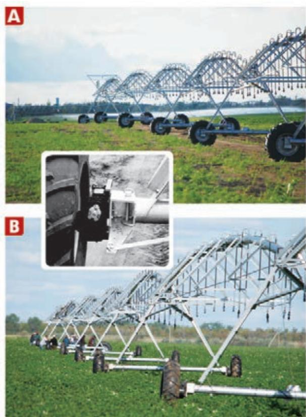
在中心支轴上装有3个或4个轮胎。当某一块地灌溉结束后，可将喷灌机拖到另外一块地上继续喷灌，这种设计可以实现一台机器灌溉多处地块，大大节约单位面积的投资成本。
