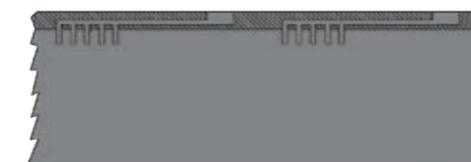
迷宫流道及滴孔一次真空整体热压成型、粘合性好，制造精度高
