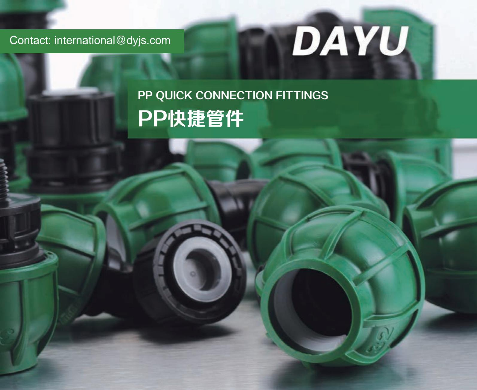
PP快捷管件常用在压力高达1.0Mpa的液体和饮用水输送中，也适用于农田灌溉、农业大棚。可防紫外线，耐腐蚀。
