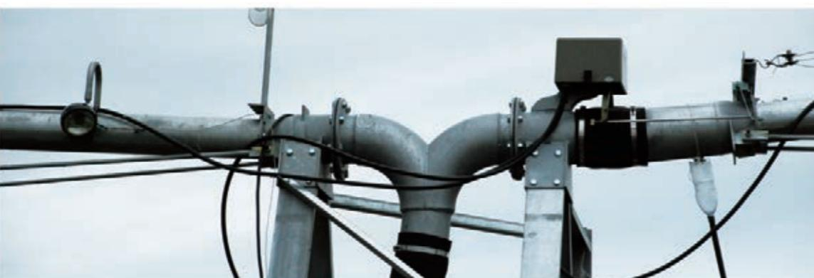
渠道供水，主机自带柴油发动机、发电机和水泵，渠中水泵吸水管带自清洗过滤装置，导向系统一般采用钢缆引导，渠道可在中间，也可放在喷灌机的一端。单机控制面积为975亩至1950亩。
